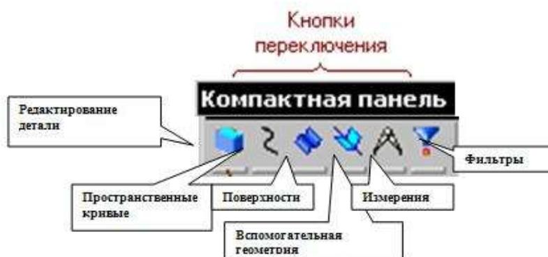
Рисунок 3 Компактная панель
